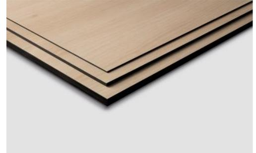
EGGER Kompaktplatten schwarzer Kern sind Kompakt-Schichtpressstoffe nach EN 438-4 bzw. EN 438-8 mit schwarzem Kern. Sie sind mehrschichtig aufgebaut und bestehen aus melaminharzimprägniertem Dekorpapier als Deckschicht und einer faserhaltigen, mit wärmehärtbaren Harzen gebundene Kernschicht.
